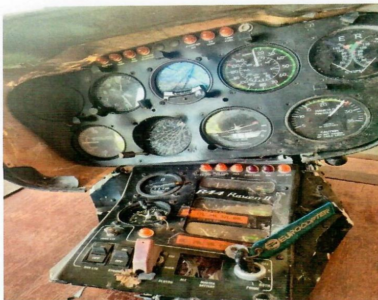
Vue du tableau de bord récupéré de l'épave de l'hélicoptère accidenté.
