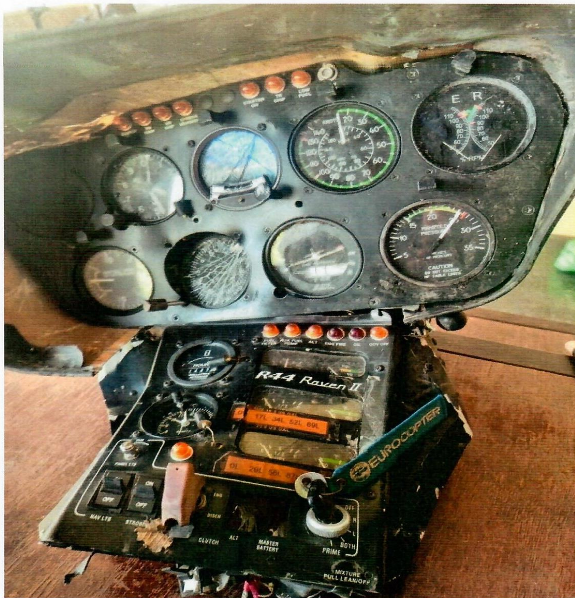
Vue du tableau de bord de l'hélicoptère dont la clé de contact fêlée est en position Off.
